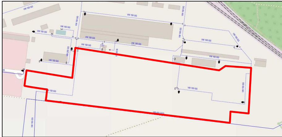
Leitungsnetz Trinkwasser mit Geltungsbereich des B-Planes
