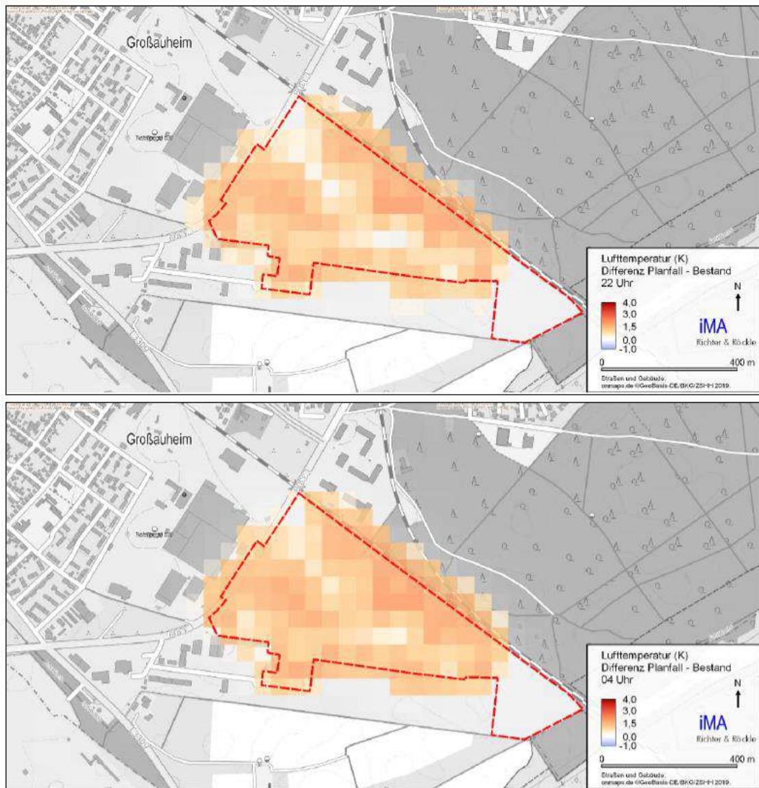
Abb. 56: Differenz der Lufttemperatur (Planfall 1 - Bestand) in 2 m über Grund in den Abendstunden (oben) und in der zweiten Nachthälfte (unten).
