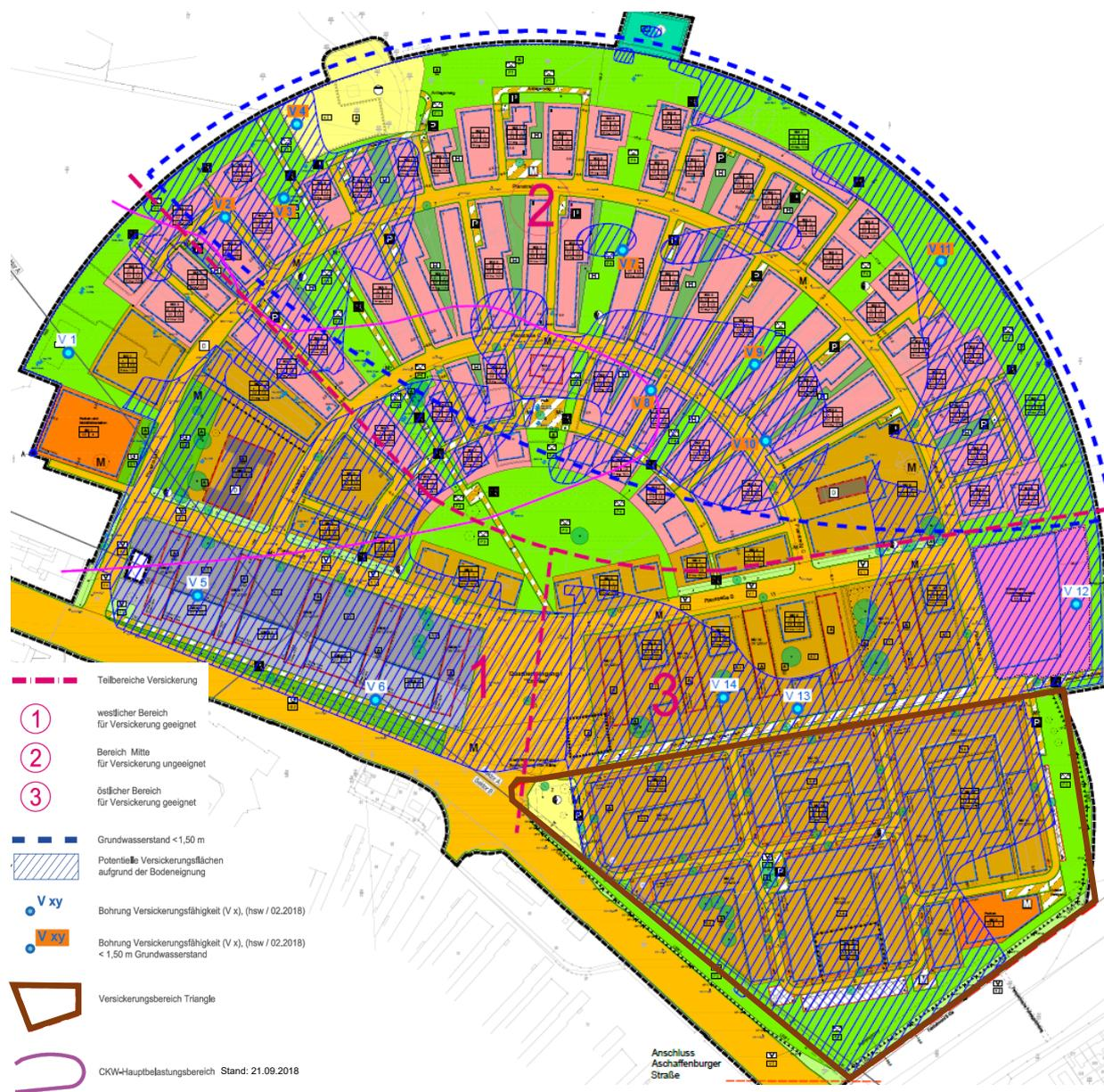
**Abbildung 25: Lageplan Versickerung**
